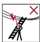
**WAARSCHUWING** – Gevaar door elektriciteit. Beoordeel alle elektrische risico's in het werkgebied, zoals leidingen en andere elektrische apparatuur. Gebruik de ladder niet waar elektrische risico's bestaan.
